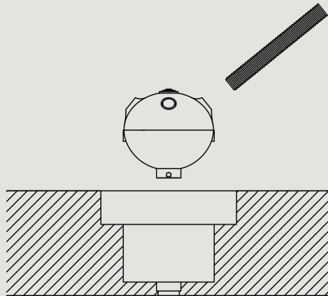
Dass es von GEORG BECHTER LICHT auch Einbaulösungen für Holz gibt, ist fast schon Ehrensache. Das SYSTEM DOT 28 bietet durchdachte Einbaulösungen sowohl für Massivholzdecken als auch für abgehängte. In Massivholzdecken wird die Holzkapsel von hinten eingefräst. Die Elektroinstallationen erfolgen somit geschützt. Auf der Deckenunterseite bleibt nur ein Loch von 28 mm Durchmesser, bereit für die rahmenlose Aufnahme der Leuchtkörper und Kabelauslässe.
