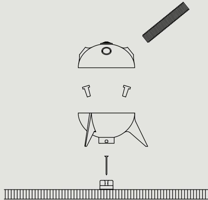
Unser Einbaumodul fügt sich als flächenbündiges System in den Sichtbeton. Die Kapseln werden einfach und werkzeuglos eingegossen. Sie werden zu einer ungestörten Lösung für Deckenleuchten, zum Verbindungselement von Material und Licht. Die Module sind einfach, variabel, montagefreundlich und präzise.
