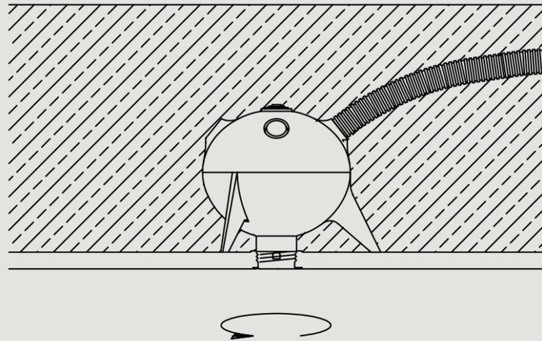
Die meisten Decken werden verputzt oder verspachtelt. Ein guter Grund unser bewährtes System auszuweiten. Die PUTZKAPSEL kann mithilfe des Putzrings an die gewünschte Putz- oder Spachtelstärke angepasst werden. Durch die Abdeckung bleibt die Aufnahme im Bauprozess geschützt und sauber. Sichtbar bleibt eine 28 mm große Öffnung, in die sämtliche Leuchten des SYSTEM DOT 28 sowie der Baldachin-Auslass flächenbündig und mit wenigen Handgriffen eingebaut werden können.
